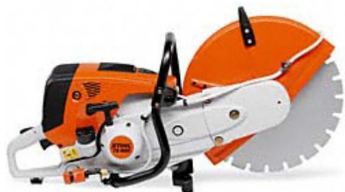
Надежден ъглошлайф с филтрираща система с продължително действие и предфильтър Циклон. Покрива нормите за вредни емисии в изгорелите газове EPA II и EU II. С ergonomичен дизайн с оптимизирани положения на ръкохватката. Оборудван с устройство ElastoStart, компенсатор и декомпресионен вентил. Серийно окомплектован с водна връзка и абразивен диск (диаметър 400 мм). Използва се за ръчно рязане или с количка FW 20.
